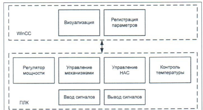
Рис. 2. Функциональная структура системы управления
